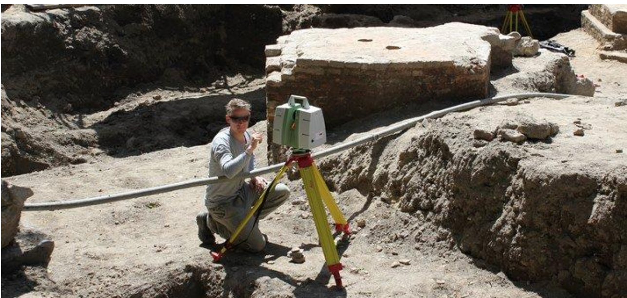
Een 3D scanoperator die de 3D scanner waterpas heeft gezet en nu de juiste instelling controleert.
