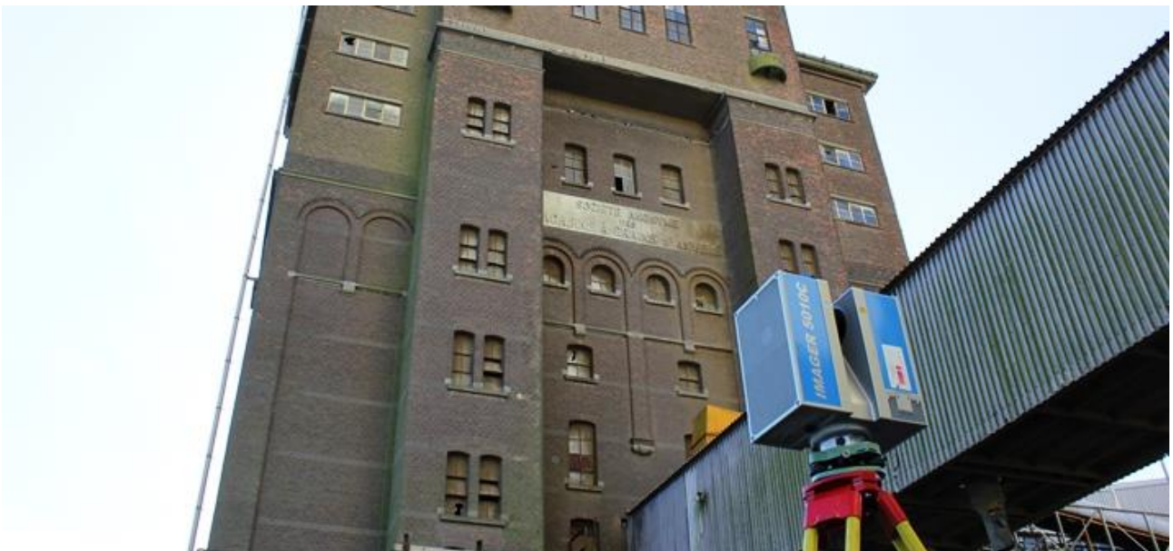
Een nauwkeurige high-end phase scanner, gebruikt voor het inscannen van gebouwen en installaties.
