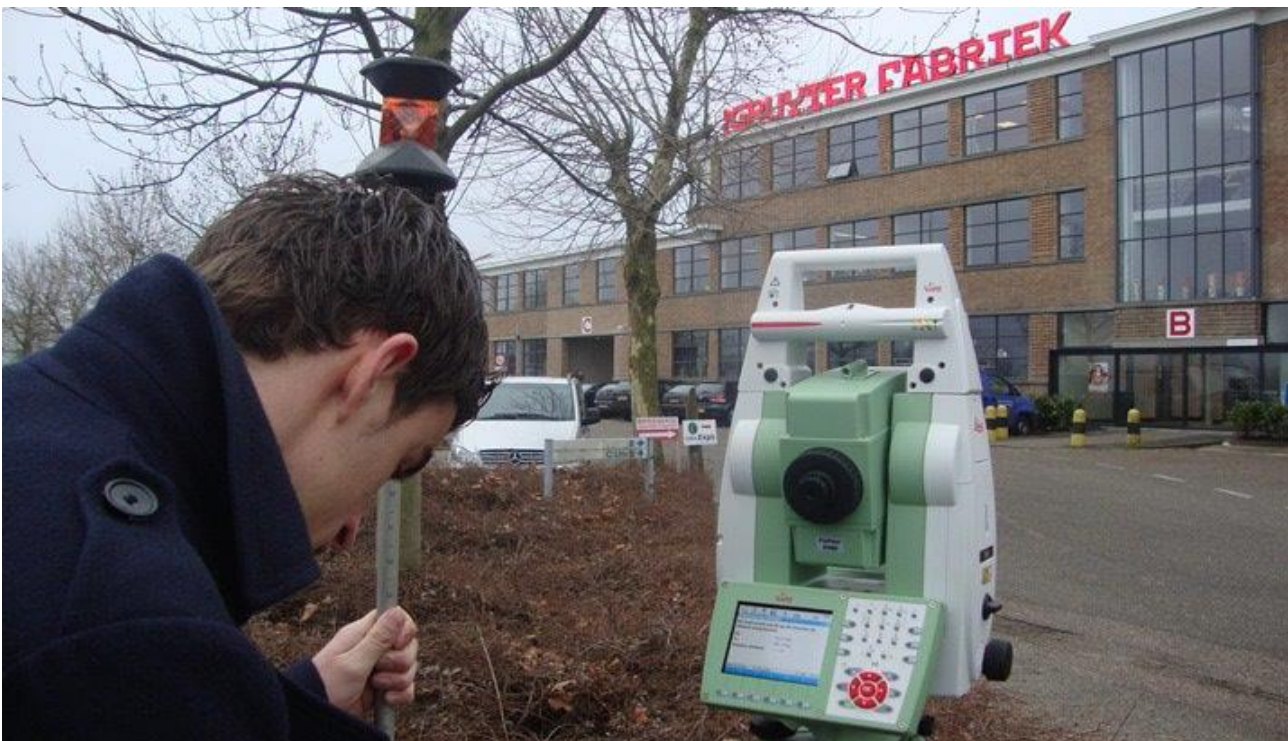
De afbeelding hierboven laat een robotic total station zien. Dit is geen scanner.
