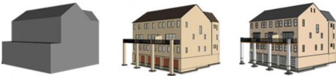
Fig 2: Van links naar rechts: LOD100, LOD200 en LOD300
